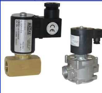
maneeventielen voor diesel / mazout volgens EN 264 normaal gesloten binnenwerk messing/RVS / NBR dichting temp. : -5°C +60°C 24 - 230 VAC fig 625 : 3/4" - 2" / max 4 bar / messing huis fig 626 : 3/4" - 2" / max 8 bar / aluminium huis veer temp. : 0°C +60°C
