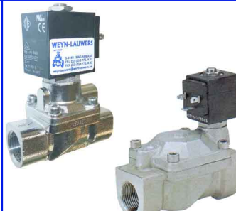
RVS 2-weg magneetventiel normaal gesloten huis : inox 316 / PTFE (teflon) dichting 24 - 48 - 230 VAC / 12 - 24 VDC fig 607 : FF 1/4" bsp geen verschilddruk nodig temp. : -40°C +180°C fig 608 : FF 3/8" - 1" bsp min. verschilddruk nodig : 0,5 bar temp. : -10°C +180°C
