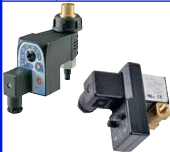
magneetventiel met ingebouwde timer 2-weg magneetventiel normaal gesloten wordt gebruikt als automatische aflatkraan fig 636 : 1/2" M x 3/8" M + slangpilaar 10 mm fig 637 : FF 1/8" bsp
