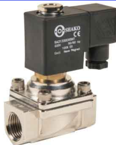
2-weg magneetventiel normaal gesloten directwerkend = geen verschilddruk nodig fig 627 : (SPU220) FF 1/2" - 3/4" bsp huis : RVS / viton dichting temp. : -10°C +90°C 24 - 48 - 230 VAC / 12 - 24 VDC fig 628 : (SPU220-X) FF 1/2" - 3/4" bsp Ex-uitvoering ATEX EEx m II 2G/D T4 voor zones 1, 21, 2 en 22
