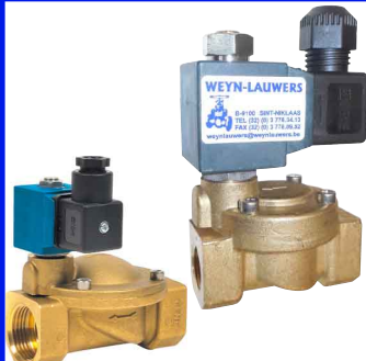
2-weg magneetventiel normaal gesloten minimum verschilddruk nodig : 0,3 bar fig 621 : (ESM86) FF 3/8" - 3" bsp huis : messing NBR dichting temp. : -10°C +80°C 24 - 48 - 230 VAC / 12 - 24 VDC fig 622 : normaal open(ESM87) FF3/8"-3"bsp
