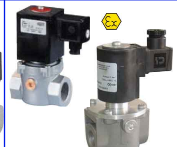
2-weg magneetventiel normaal gesloten voor gassen : aardgas-propaan-methaan-lpg fig 631 : (EVP) 1/2"-2" bsp - max 360 mbar huis : aluminium temp. : -20°C +60°C 24 - 230 VAC ATEX EEx II 3G/D voor zones 2 en 22 fig 632 : (EVP-6) 1/2"-2" bsp - 6 bar
