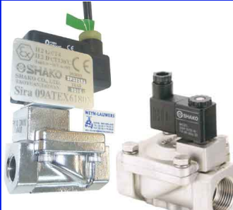
inox 2-weg magneetventiel normaal gesloten minimum verschilddruk nodig : 0,5 bar fig 629 : (SPU225) FF 3/8" - 2" bsp huis : RVS / viton dichting temp. : -10°C +90°C 24 - 48 - 230 VAC / 12 - 24 VDC fig 630 : (SPU225-X) FF 3/8" - 2" bsp Ex-uitvoering ATEX EEx m II 2G/D T4 voor zones 1, 21, 2 en 22
