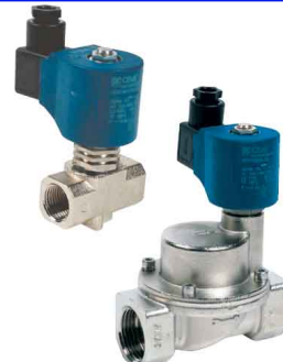
2-weg magneetventiel normaal gesloten minimum verschilddruk nodig : 1,0 bar fig 624 : (ESV90) FF 1/2" - 2" bsp huis : messing teflon dichting temp. : -40°C +180°C 24 - 48 - 230 VAC / 12 - 24 VDC
