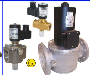
2-weg magneetventiel normaal gesloten met manuele reset voor gassen : aardgas-propaan-methaan-lpg 24 - 230 VAC ATEX EEx II 3G/D voor zones 2 en 22 gasdruk max. 500 mbar of 6 bar naar keuze fig 634 : (M14) 1/2"-1" bsp : huis messing : (M14) 5/4 - 2" bsp : huis aluminium fig 635 : (M16) DN65-DN300 : huis aluminium fig 633 : (EVP) DN65-DN100 max 360 mbar
